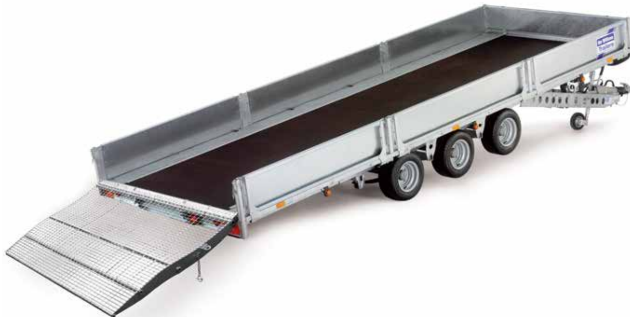
Model TB5521-353 (drie-asser) met voorbord, zijborden en een oprijklep uit 1 stuk
